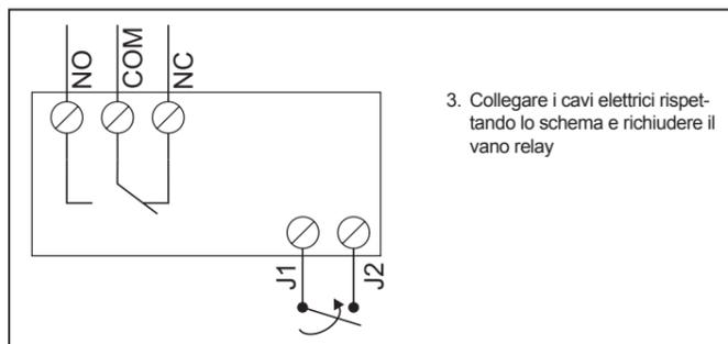
3. Collegare i cavi elettrici rispettando lo schema e richiudere il vano relay
